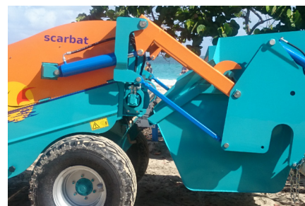
Pistones de elevación y giro de la tolva
