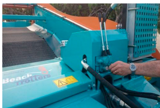
Leviers de contrôle du rouleau frontal de la maille
