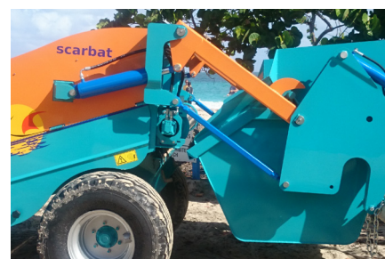
Pistons d'élévation et de basculement de la benne
